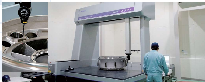
大型CNC三次元測定機(高速5軸ヘッド搭載)による測定
