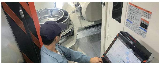
立形複合加工機での航空機エンジン部品の5軸加工
