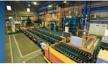
金属熱処理設備【真空浸炭炉】
