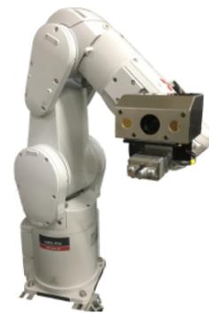
ロボット搭載を前提とした設計です。サイズ 112(W)x65(H)x105(D)、重量 (850g)、高精度、低価格です。
