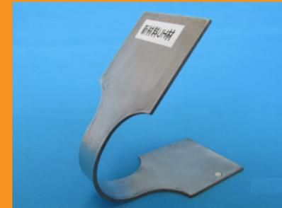
マグネシウム合金は実用金属中最軽量であり、製品の軽量化・小型化に最適な合金です。
