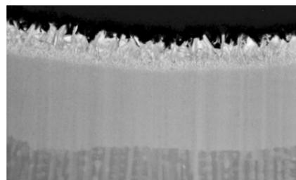
ヤギマイトはアルマイト皮膜の最表面に厚さ1μm程の新たな層を形成し、超耐食性を確保する技術のご紹介です。
