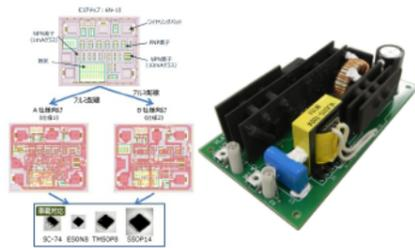
あらかじめトランジスタ、抵抗を配置したコアチップを準備しておき、お客様の回路に応じて、アルミ配線を施し、チップを完成させます。
