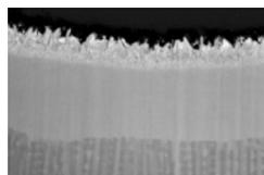
アルマイト皮膜の最表面に厚さ1μm程の新たな層を形成し、超耐食性を確保する技術です。
